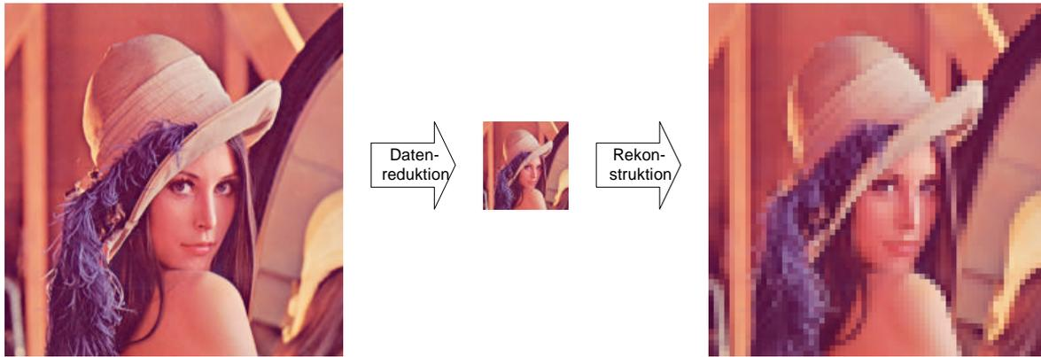
Abbildung 3: Eine einfache Datenreduktion durch Verkleinerung des Originalbildes auf 1/16 der ursprünglichen Größe, wodurch 94% der Bildpunkte wegfallen. Die Rekonstruktion auf die Originalgröße rechts zeigt deutlich sichtbar die Einbußen der Bildinformation.
